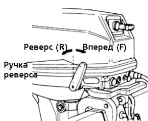
(2) Назад. Как и при переключении вперед, сбросьте обороты мотора, затем быстро переведите рычаг в положение "назад" - Reverse(R)
