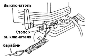
Нажмите на выключатель, чтобы заглушить мотор.
