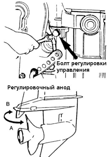
Если лодка движется не прямолинейно, отрегулируйте положение регулировочного анода, расположенного под антикавитационной плитой.
