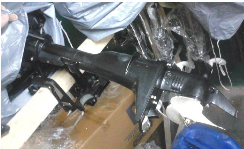
Заполните редуктор маслом через контрольное отверстие шприцом с перерывом в 2 минуты (1 шприц - перерыв 2 минуты) до полного состояния.
